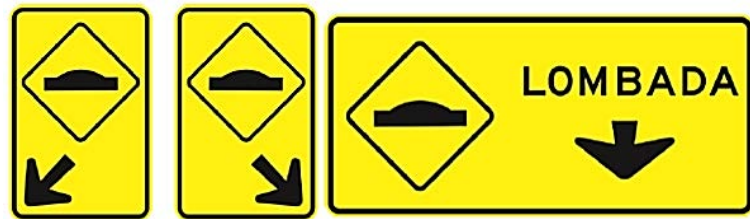
Figura 74. Sinalização de advertência aplicada em lombadas.
