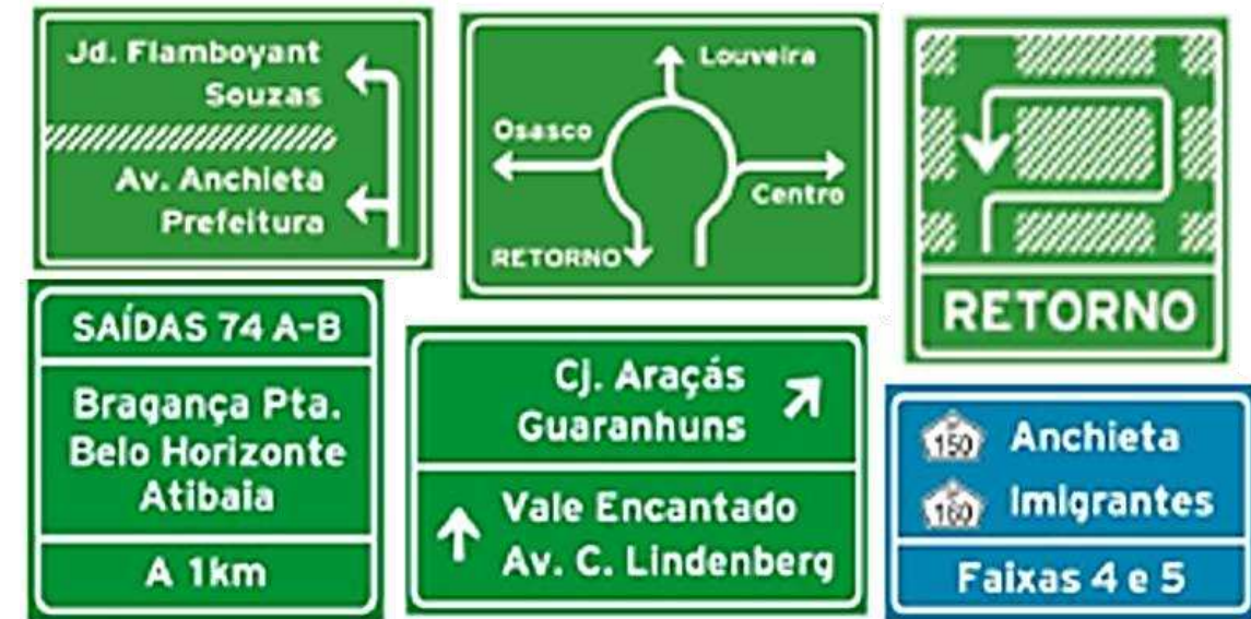
Figura 62. Placas de orientação de destino.
